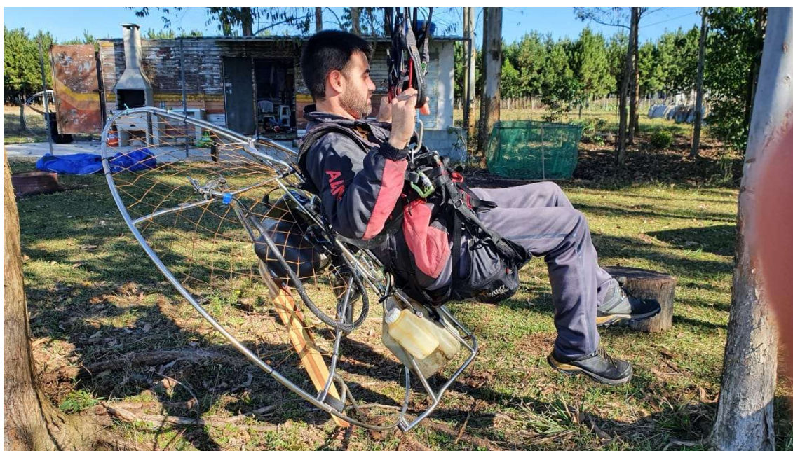
Figura 10: Ancoragem mal regulada, muito inclinada
