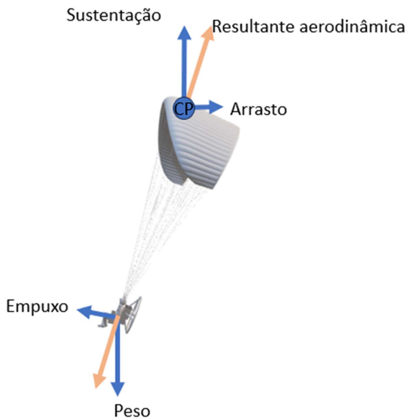
Figura 4: Forças aerodinâmicas envolvidas no voo de Paramotor.
